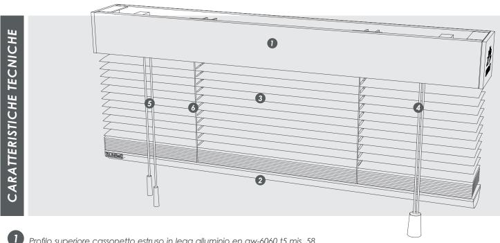
Profilo superiore cassonetto estruso in lega alluminio en aw-6060 t5 mis. 58 x 52 x sp 1 mm verniciato a polvere in abbinamento tinte lamelle come da campionario, munito di appositi tappi laterali di chiusura con logo stampati a disegno.
