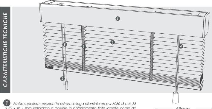
x 52 x sp 1 mm verniciato a polvere in abbinamento tinte lamelle come da campionario, munito di appositi tappi laterali di chiusura con logo stampati a disegno.
