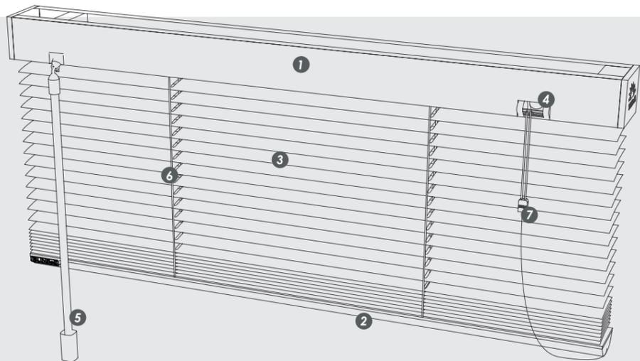
**1** Profilo superiore cassonetto estruso in lega di alluminio en aw-6060 t5 mis. 27,6 X 29 X sp. 1 mm verniciato a polvere in abbinamento tinte lamelle come da campionario Silver, fornito di aletta parasole **a** in chiusura alla prima lamella sul lato esterno e munito di appositi tappi laterali di chiusura stampati a disegno.
